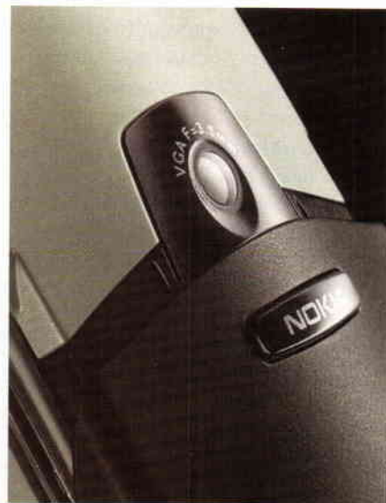
A beépített kamerával akár 640x480 felbontású VGA képek is készíthetők.
