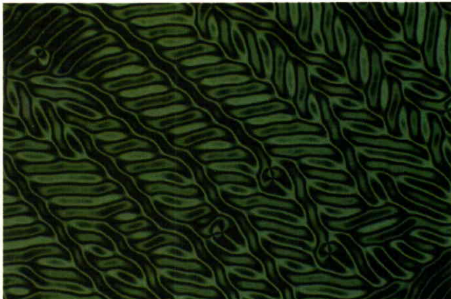
Az LCD-kben használt folyadék-kristályok általában hosszú molekulákból állnak.
